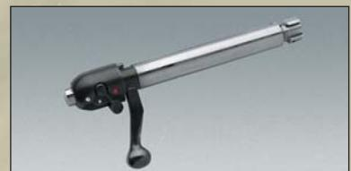
Поворотный затвор, с тремя боевыми упорами. Угол поворота рукоятки затвора всего 54 градуса. В задней части стебля затвора смонтирован рычажок предохранителя, имеющий три положения. В среднем положении блокируется спусковой крючок, тогда как рукоятка затвора может быть перемещена для разряда карабина. Спусковой механизм со шнеллером.
