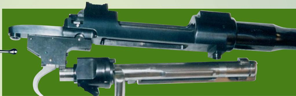
**Брусок стали весом 14,8 кг в процессе изготовления превращается в ствольную коробку массой чуть более килограмма**
