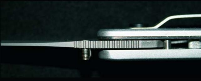
На фотографиях хорошо видны элементы рифления, выполненные на пластине фиксатора и обухе клинка, предотвращающие скольжение пальцев и делающие хват ножа в «рабочем» положении более удобным. Рукоять вполне соответствует параметрам руки жителя Европы. На множестве ножей этим пренебрегают, нередко превращая пользование ими в мучение.
