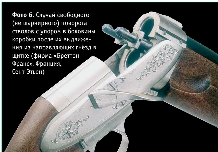
**Фото 6.** Случай свободного (не шарнирного) поворота ствольного блока с упором в боковины коробки после их выдвижения из направляющих гнёзд в щитке (фирма «Бреттон Франс», Франция, Сент-Этьен)
