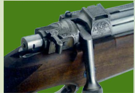
*Чтобы снять винтовку Прехтля с предохранителя G0Lmatic нужно, нажав указательным пальцем на стопорную клавишу, большим продвинуть рычажок в среднее положение, из которого оружие легко перевести в положение «огонь»*
