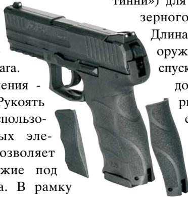
пистолета интегрировано крепление (рельс «пикатинни») для фонаря или лазерного целеуказателя. Длина ствола - 98 мм, вес оружия - 655 г. Усилие спуска 50 Н (самовзвод) и 20 Н (с предварительным взведением). Ёмкость магазина - 15 патрон, габариты (ДхВхШ) - 180 x 135 x 34,5мм.
