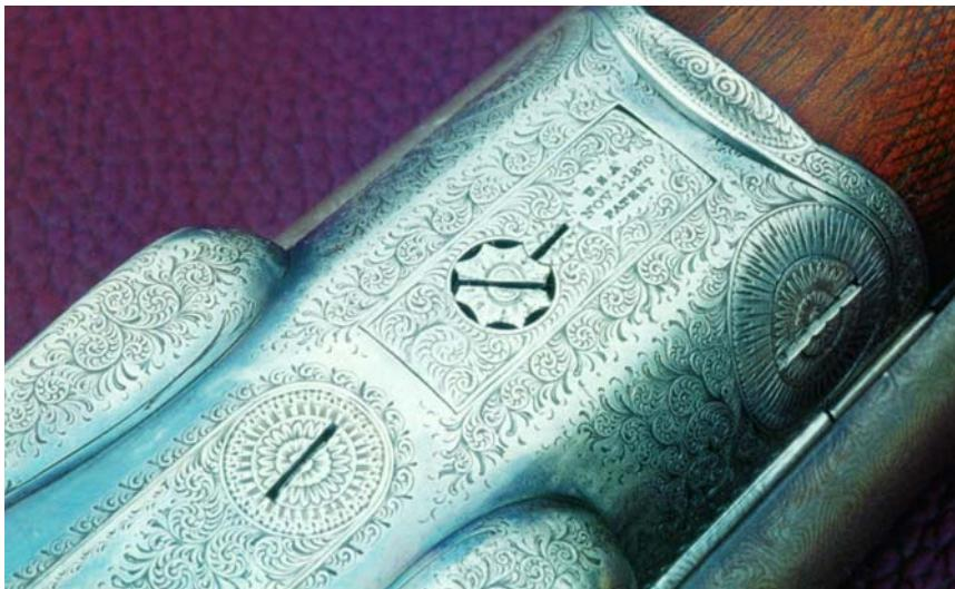
**Фото 1.** Двустрелка компании «В. и Ч. Скотт и сын» (Англия, Бирмингем, конец XIX в.) с передним составным крюком. На его торце виден регулировочный винт, позволяющий выбирать зазор между щитком коробки и казённым срезом стволов (BP № 452, 1870). Прилагаемый рисунок наглядно иллюстрирует механизм устранения люфта в процессе эксплуатации ружья.
