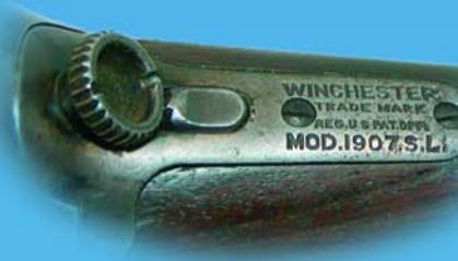
*Винт на задней поверхности ствольной коробки, служащий для разборки оружия*
