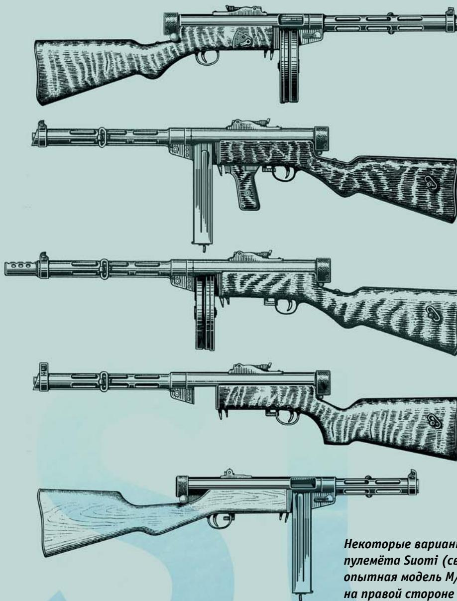
*Некоторые варианты и модификации 9-мм пистолета-пулемёта Suomi (сверху вниз): опытная модель M/31 с предохранителем-переводчиком на правой стороне ложи, серийный M/31 с дополнительной рукояткой, вариант M/31 SJR с дульным компенсатором, датский пистолет-пулемёт Madsen-Suomi P2, шведская укороченная модель M37-39*
