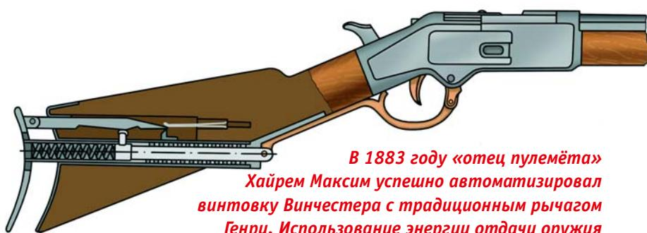
*В 1883 году «отец пулемёта» Хайрем Максим успешно автоматизировал винтовку Винчестера с традиционным рычагом Генри. Использование энергии отдачи оружия шло через подвижный затылок приклада*
