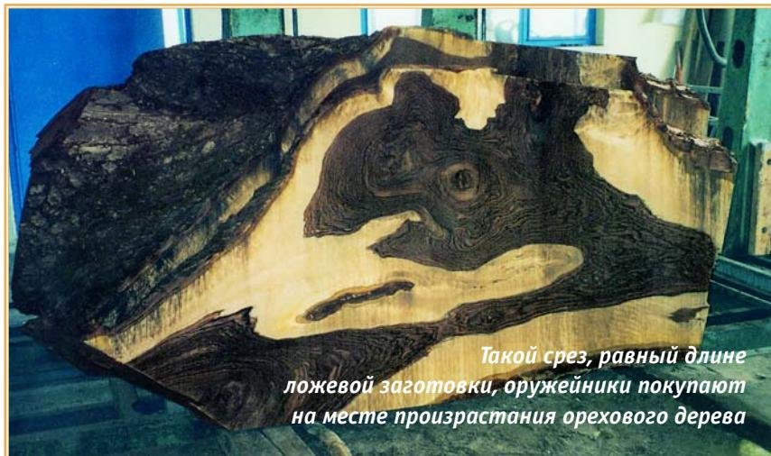
горного ореха плотная, пористость его незначительная: и по количеству пор, и по их размерам. Текстура очень богатая и выразительная, как по рисунку, так и по оттенкам, особенно в прикорневой и комлевой частях ствола. Кроме того, древесина грецкого ореха прочна и не так склонна к скальванию в отличие, скажем, от берёзы и бук. Именно эти качества и сделали горный грецкий орех практически идеальным и непревзойдённым до сих пор ложевым материалом.
