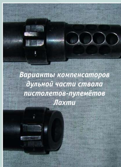
*Варианты компенсаторов дульной части ствола пистолетов-пулемётов Лахти*
