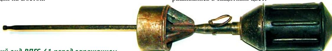
Внешний вид ВПГС-41 перед заряжанием в винтовку (стабилизатор в переднем положении)
