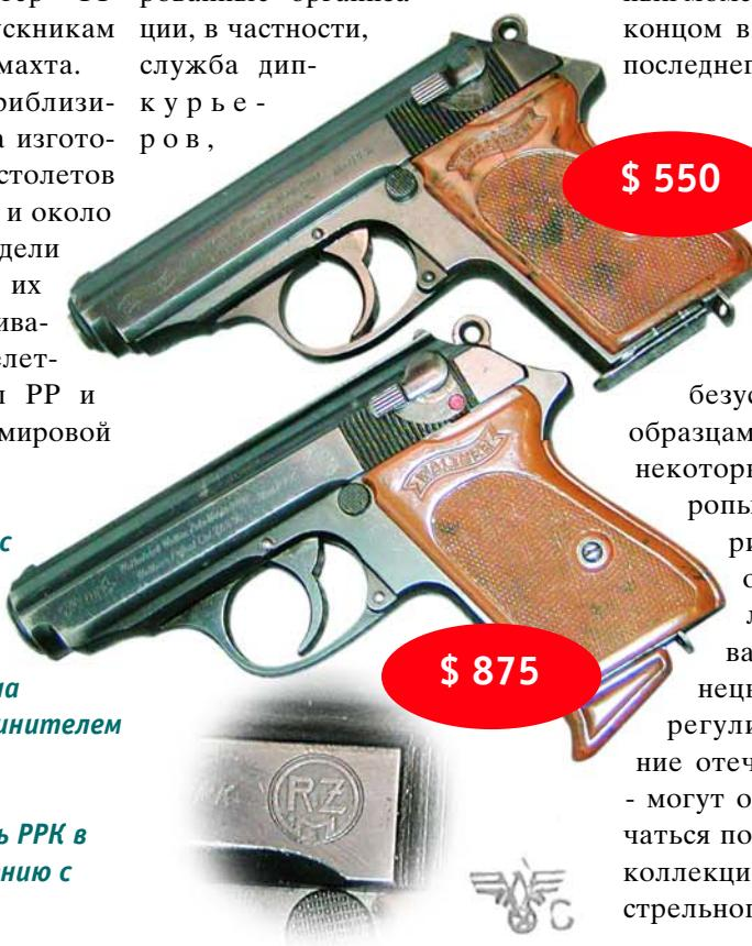
**В цене образца имеет значение всё: сверху - РРК с углом поворота флагжа предохранителя на 60°, снизу - с углом поворота флагка предохранителя на 90° и пластмассовым удлинителем на крышке магазина**
